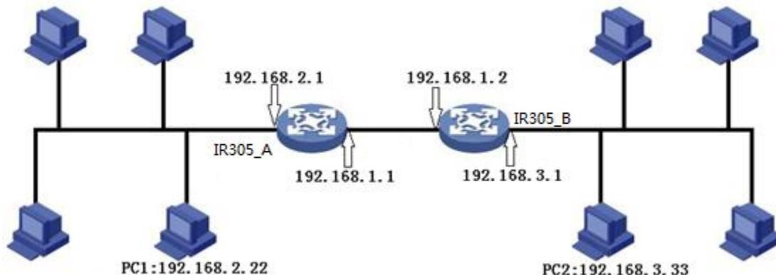
第一步：配置 IR315\_A。点击“网络>>OSPF”，“路由 ID”自定义填写但保证与 IR315\_B 在一个网段。在“网络”表中配置 IR315\_A，宣告该设备的路由条目。
